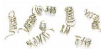
Свободно намотанная (витая) стружка идеальные условия резания
