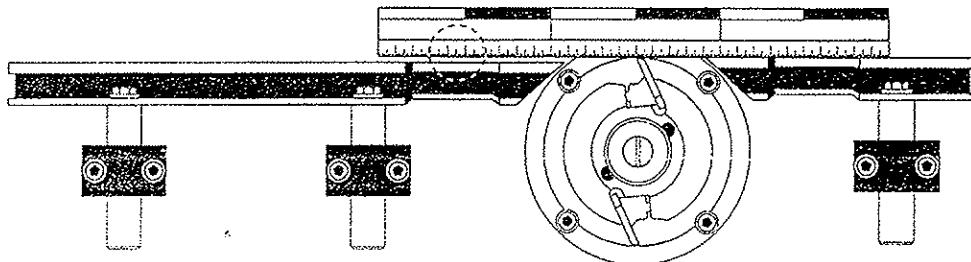
Передняя направляющая (62) регулирует площадь строгания доски.
