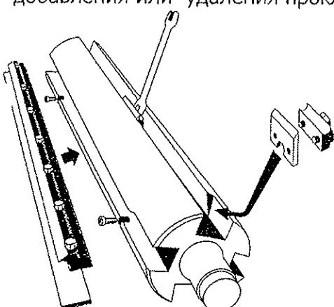
Запомните, что пластина прокладки может быть установлена двумя способами.
