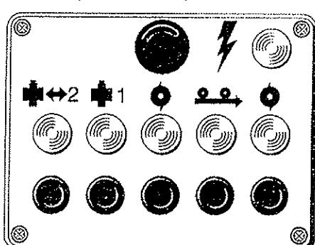
Кнопки нижнего ряда включают различные двигатели с подтверждением работы двигателя лампой индикатором под каждой кнопкой соответственно.
