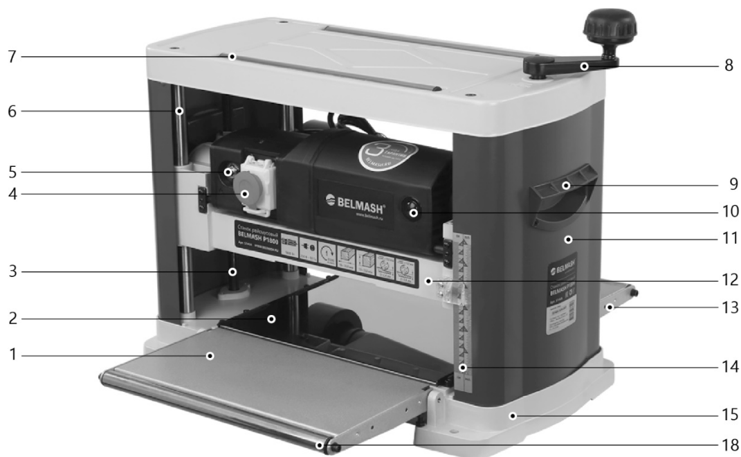
Рисунок 1. Основные элементы станка BELMASH P1800
