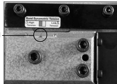
Регулировка натяжения полотна без использования датчика контроля натяжения (Н):
