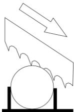
**ВНИМАНИЕ:** Всегда устанавливайте на станок пильное полотно с размерами, указанными в данной инструкции, и для которого настроены направляющие блоки. В случае установки пильного полотна другого размера см. пункт «Описание рабочего цикла».
